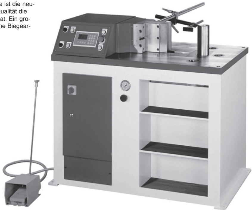
Abkantwerkzeug mit Multi-V-Matrize und Stempel für Dünnblech
