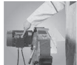
Schalter und Notaus sind nicht durch die Klappe verdeckt und können schnell und problemlos erreicht werden
