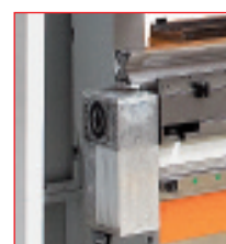
WILA motorisch Bombiereinrichtung (Standard)
