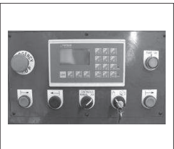
Bedienfeld mit Positionsanzeige und Biegewinkelspeicher
