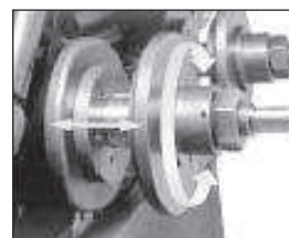
Schnelle Einstellung der Präzisionswerkzeuge durch Gewindewellen
