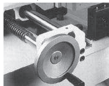
Handrad zur Einstellung der Y-Achse
