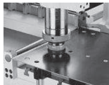
Trumpf-Stanzwerkzeuge mit Polyurethanabstreiter
