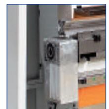
motorische Bombiereinrichtung (Standard)
