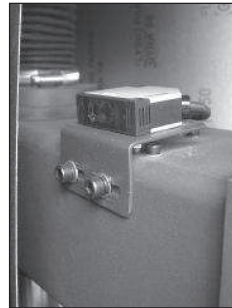
Photozelle zur automatischen Schleifbandsteuerung, pneumatisch reguliert
