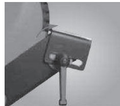
schrägstellbare Auflage ermöglicht das Abschleifen im passenden Winkel
