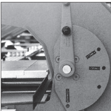
Oberwangenverstellung manuell Ausgleich unterschiedlicher Blechstärken (Option)
