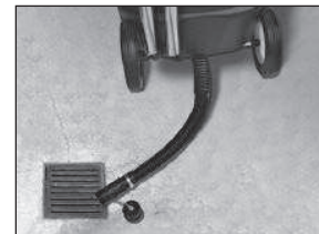
Schmutzwasser-Ablaß- schlauch im Behälterboden
