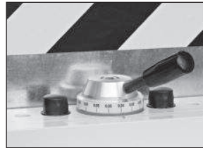
Schnittpaltverstellung
