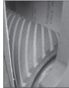
Gummierte Kontaktwalze mit Luftablassrillen an Breitbandschleifstation
