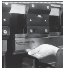
Zwischenstücke-Promecam mit Schnellklemmung für Oberwerkzeug
