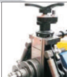
Zustellung der Oberwalze, sehr leichtgängig durch Übersetzungsgetriebe
