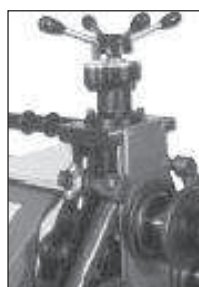
manuelle Zustellung mittels mechanischer 2 Geschwindigkeiten Untersetzungsgetriebe, um den Kraftaufwand des Bedieners minimal zu halten
