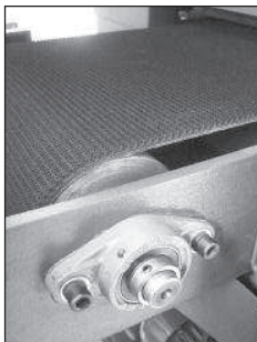
Robuster, hitzebeständiger Transportriemen mit groß dimensionierter Reinigungsbürste an der Unterseite
