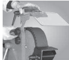
ohne Werkzeug demonstrierbarer Anschlag zur Freilegung der gesamten Schleiffläche
