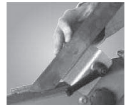
stufenlos einstellbarer Anschlag oben ermöglicht schnelles und bequemes Anschleifen der Werkstücke
